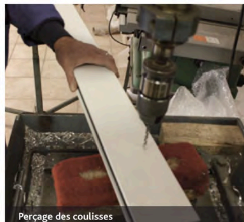
Perçage des coulisses
